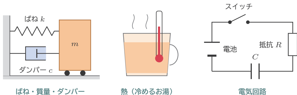
図10 この巻でくり返し出てくる3つの場面。ばね・ダンパーの k \cdot c \cdot m 、回路の R \cdot C は、それぞれの章で説明する。
