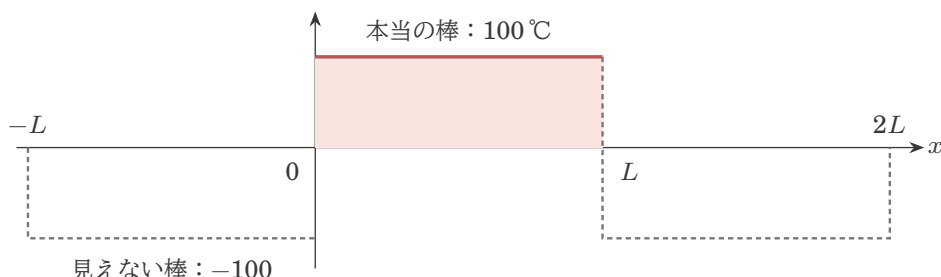
図9 0 から L だけの温度 (赤) を、原点で半回転した形 (灰色の点線) に広げると、周期 2L の方形波になる。0 から L の所では、もとの温度と同じ。
